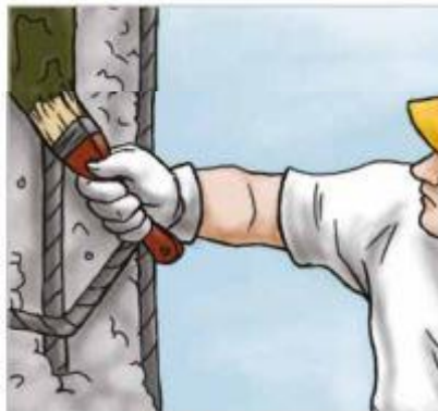
■ Trattamento dei ferri d'armatura con DRACOSTEEL.
